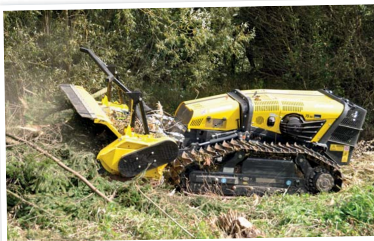
RoboMAX s ocelovým pásovým podvozkem a frézou pro drcení klestu
